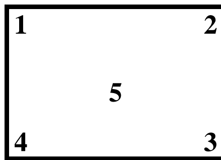
Rys.2. Rozmieszczenie punktów pomiarowych gęstości mocy promieniowania, natężenia światła i temperatury dla badanego modułu
