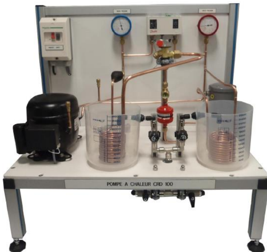
Rys. 9. Widok stanowiska pomiarowego do badania pompy ciepła
