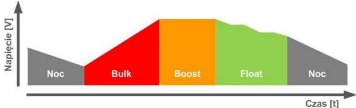
Rys.4. Etapy procesu ładowania magazynu energii z wykorzystaniem regulatora ładowania metodą PWM
