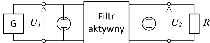
3.1 Schemat dla pomiaru charakterystyki widmowej filtru. R=50\ \Omega
