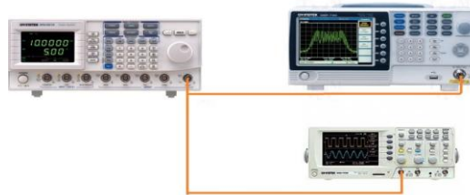
Rysunek 3.1 Schemat ideowy podłączenia generatora GFG-3015 z oscyloskopem GDS-1022 oraz analizatorem GSP-730.
